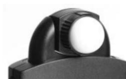
Besonders die Messung nach der Lichtmessmethode führt zu exakt belichteten Aufnahmen. Da der Strobe Master bei der Lichtmessmethode mit seinem Diffusor vom Objekt aus in Richtung Kamera das einfallende Licht misst, ist eine dem Motiv entsprechende tonwertrichtige Wiedergabe in der Aufnahme gewährleistet. Dies ist vor allem bei in sich hellen oder in sich dunklen Motiven wichtig. Auch in
